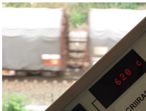
Photographie 3 : relevé radiamétrique au moyen d'un scintillomètre DG5, depuis les bureaux de la CRIIRAD, lors du passage d'un train le 29 juin 2011
