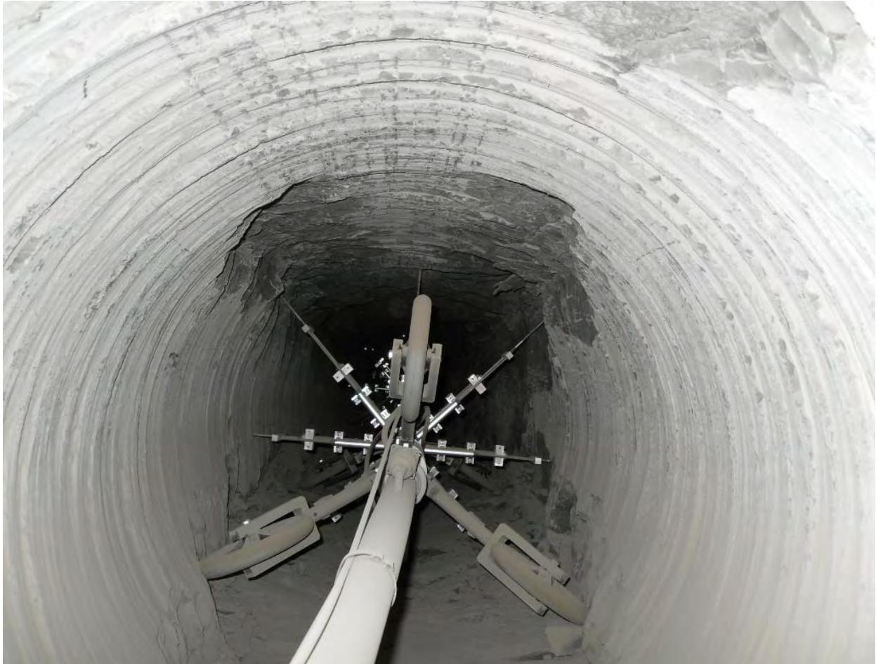
Figure 6-1 : Hors-profil par rapport à la forme circulaire d'un forage dans le laboratoire souterrain de Bure. Photo prise par Krishan Wahi, 18 août 2010.
